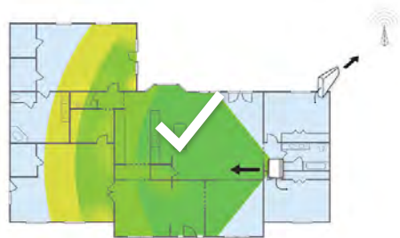
Orientez l'antenne intérieure à l'opposé de l'antenne extérieure
